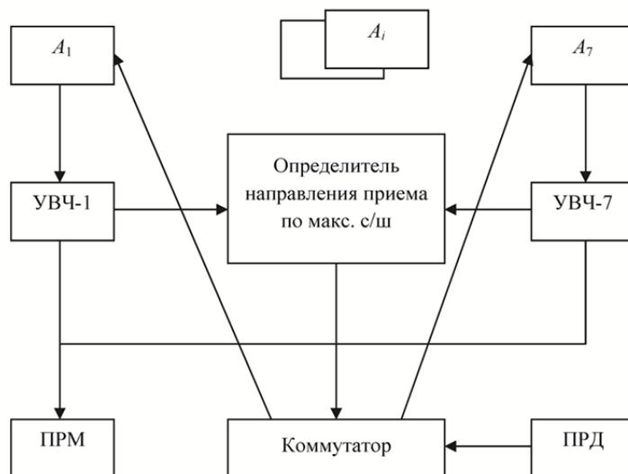
Рис. 1. Вариант беспойскового по угловым координатам вхождения в связь на основе комплекса малонаправленных антенн:
